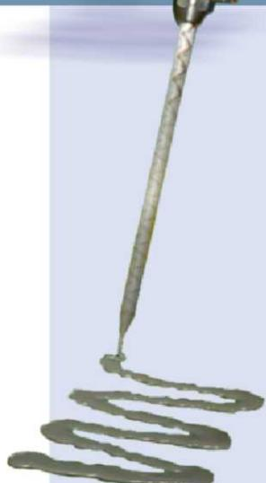
Смесительная головка выполнена в виде ручного заливочного пистолета с пневмоприводом клапанов. Перемешивание компонентов осуществляется с помощью специального неподвижного лабиринтного устройства (статического смесителя).
